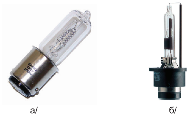
Слика 79. а / ламба со волфрамово влакно, за мерење во видливо (Vis) спектрално подрачје б/ ламба за мерење во ултравиолетово (UV) подрачје
